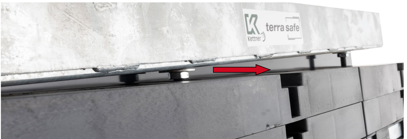
Freiraum bei aktiviertem Höhenausgleich / beispielhafte Darstellung
